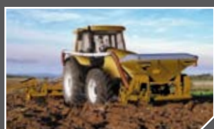
Tracteur équipé d'une trémie grande capacité à l'avant et d'un semoir en ligne à l'arrière.
