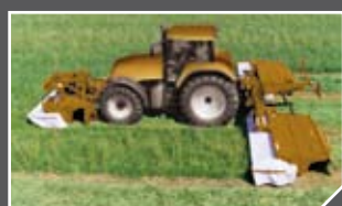
Tracteur équipé de trois faucheuses, une à l'avant, deux à l'arrière.
