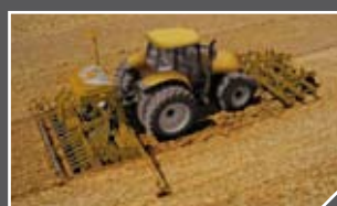
Tracteur équipé d'un déchaumeur à l'avant et d'un semoir en ligne à l'arrière.
