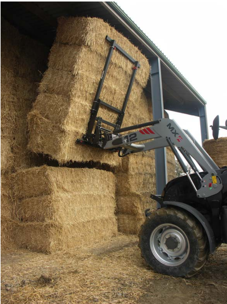
MX_L6000_rehausse.jpg : Le MANUBAL L6000, avec rehausse
