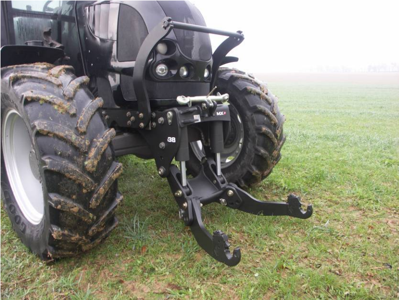
MX_RA_PM_travail.jpg : Relevage avec palonnier moulé en position travail
