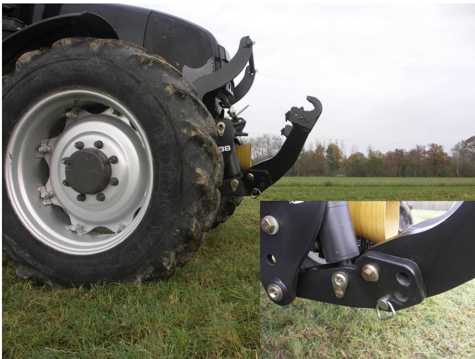
MX_RA_PM_haut.jpg : Relevage avec palonnier moulé en position de travail haute
