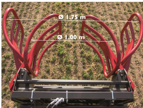
MX_C40_amplitude : Le C40 offre la plus grande amplitude d'ouverture et de fermeture. Il permet de manipuler des balles d'un diamètre compris entre 1.00 m et 1.75 m.
