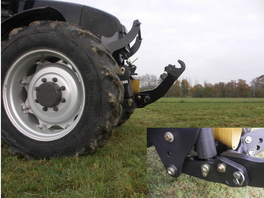
MX_RA_PM_bas.jpg : Relevage avec palonnier moulé en position de travail basse
