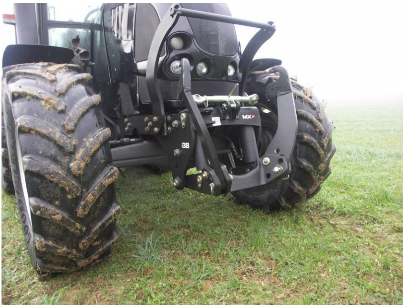
MX_RA_PM_transport.jpg : Relevage avec palonnier moulé en position transport
